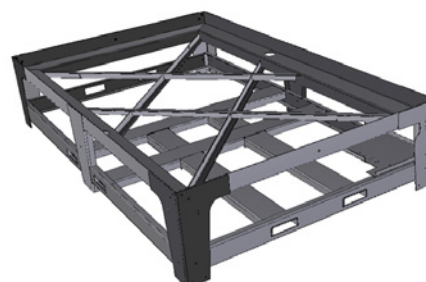
Telaio del banco da taglio rigidamente
