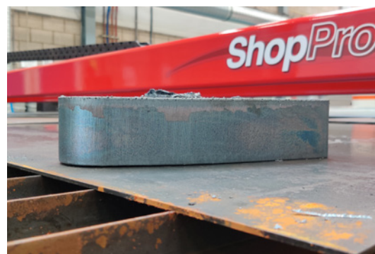
Fino a 50 mm di spessore di taglio (ossitaglio)
