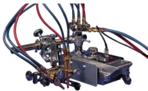
SP-300 Conjunto Antorcha ■ 2 antorchas con control de altura mecánico automático ■ Mantiene el ángulo de 2 antorchas cortes bisel precisos Y y X.
