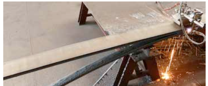
S-100 toortsset met geleider optie en laskantvoorbereiding
