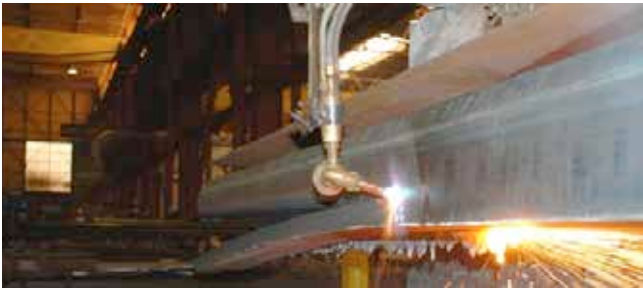
S-100 toortsset met verlenging en laskantvoorbereiding
