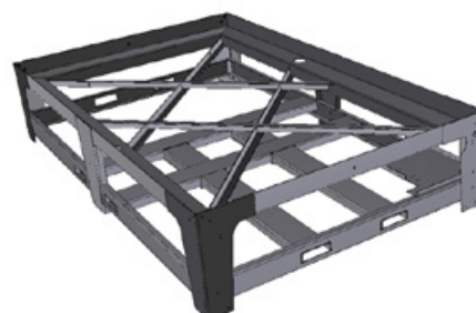
Estructura de la mesa fuertemente soldada-
