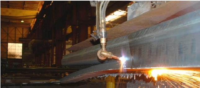
S-100 mit langer Gleitschiene und Winkeldüsenhalter
