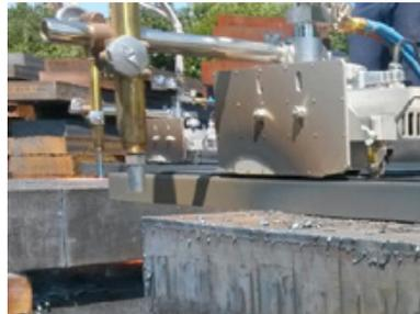
EPOCH Brennersatz mit Führungsschiene für hohe Beanspruchung
